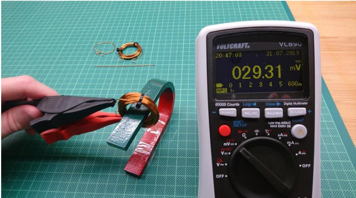
Bei der Spule mit 60 Windungen, erreiche ich nochmal eine höhere Spannung.
