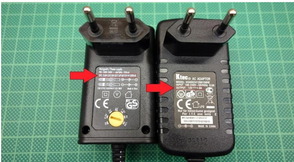
Jedes Netzteil hat eine gewisse Leistung (Watt) resultierend aus Spannung mal Strom.
