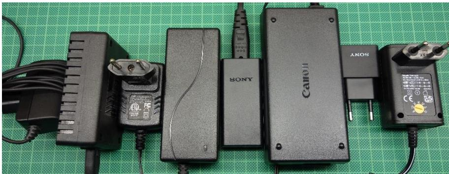
Dabei wird meistens die Wechselspannung in einem Netzteil auf eine kleine Spannung transformiert und mit einem sogenannten Gleichrichter in Gleichspannung umgewandelt.
