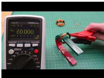
Wie man im Video sieht, zeigt das Messgerät nicht immer sauber die Spannung an. Das liegt unter anderem auch daran, dass sich die Polarität der Spannung bei jeder Bewegung der Spule im Magnetfeld ändert.
